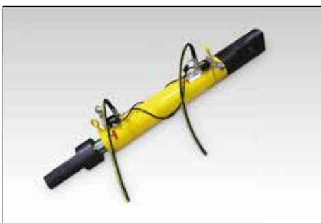
◀ Cilindros de doble efecto con válvulas de retención accionadas por piloto y ojales de vástago en ambos extremos para aplicaciones de elevación y posicionamiento.
