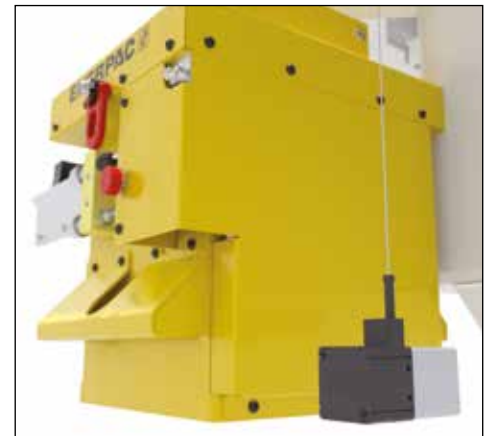
▼ El sensor opcional de carrera de cable puede proporcionar retroalimentación al control de la bomba.
