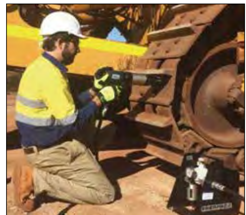
▼ Las llaves dinamométricas neumáticas de la serie PTW son ideales para aplicaciones donde la velocidad y precisión son críticas, como en el mantenimiento de orugas.
