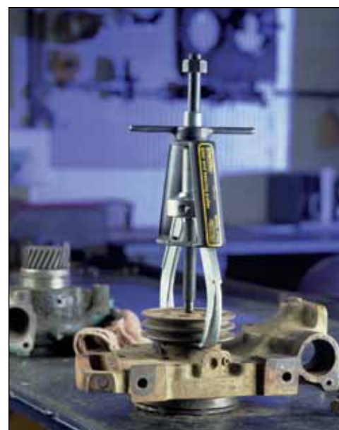
▲ Un extractor de 2 mordazas EP-204 en posición para extraer la polea de mando de una bomba de agua.
