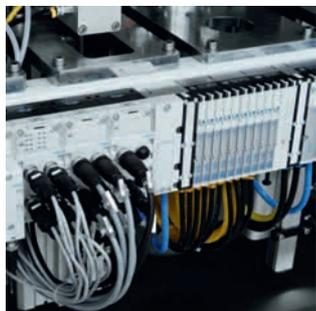
ha revolucionado el sector. En la preparación y dosificación del material, el terminal de válvulas CPX/MPA con función de diagnóstico es la cabeza de puente para el control de la máquina de nivel superior. La integración estandarizada en una red y una clara estructura de la instalación, la sencilla implementación y la elevada densidad de sus funciones se rentabilizan para CeraCon: La puesta a punto y el mantenimiento se convierten en un juego de niños.
