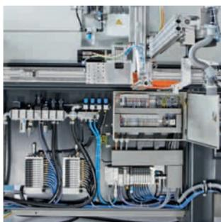
Un diseño atractivo es un factor de ventas. Esto también es válido para perfiles de aluminio y de material sintético. elumatec lo sabe: „Nuestras máquinas deben ser rápidas y precisas, y sobre todo sutiles“. Y precisamente por ello elumatec apuesta por la tecnología de los terminales de válvulas de Festo. „Para poder controlar los cilindros con presiones diferentes utilizamos la creación de zonas de presión y la concatenación en altura.“
