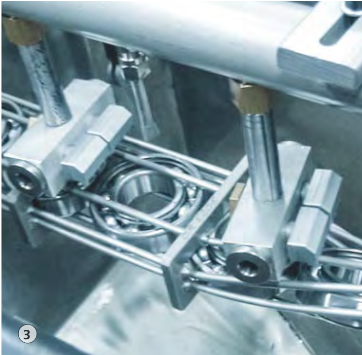
Limpieza con BOQUILLAS SILVENT 961 para reducir el ruido.
