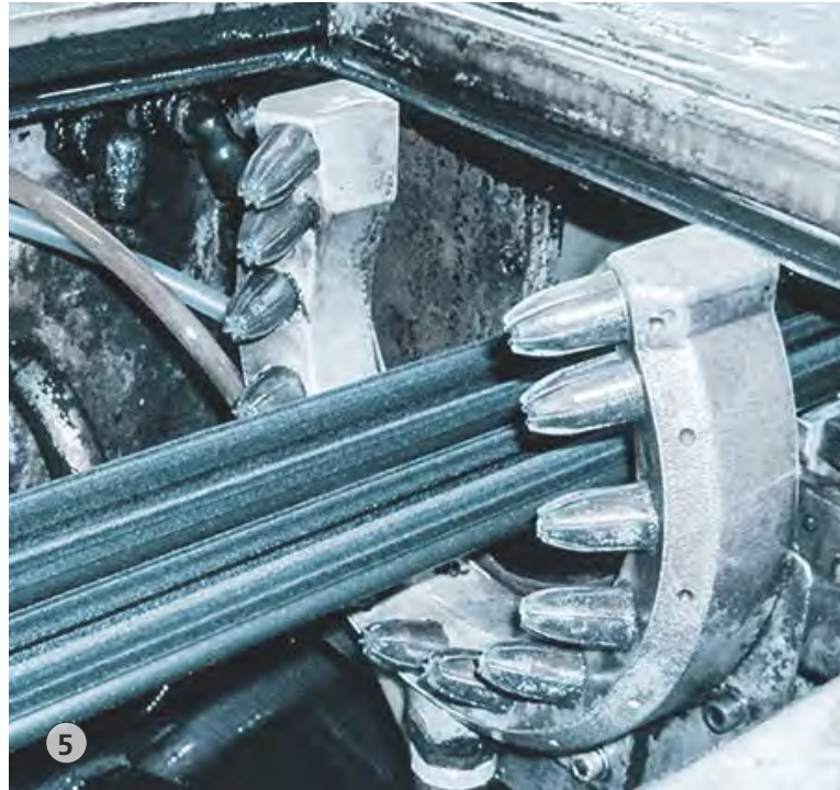
Refrigeración con BOQUILLAS SILVENT 209 L para reducir el ruido y el consumo de aire.
